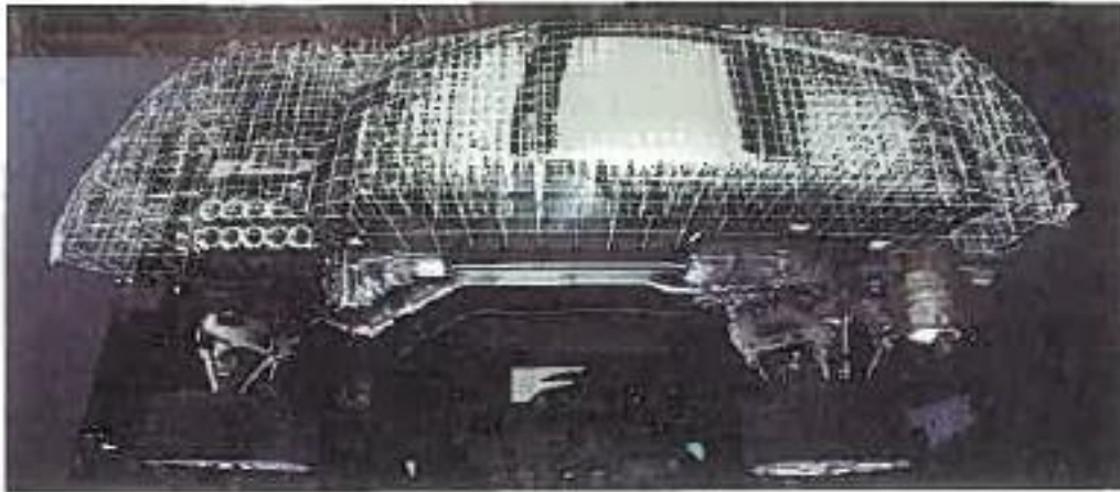
図1 トヨタ自動車「レクサスLFA」のカットモデル 排気量4.8LのV型10気筒エンジンを前部に積み、後部の変速機との間をトルクチューブでつないだトランスアクスル方式を採用。ボディの骨格はCFRP (炭素繊維強化樹脂) 製である。全長4505×全幅1895×全高1220mm、ホイールベースは2605mm。
