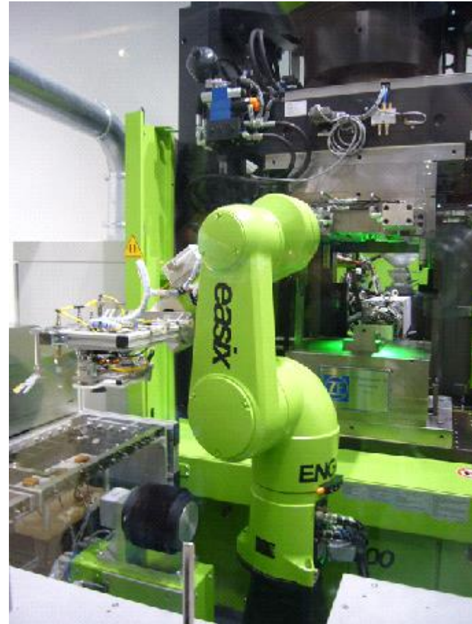
ロボットの後ろにある金型にセット
