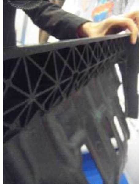
シートモーディング後、射出成形を行い、リブなどを立てて補強。
