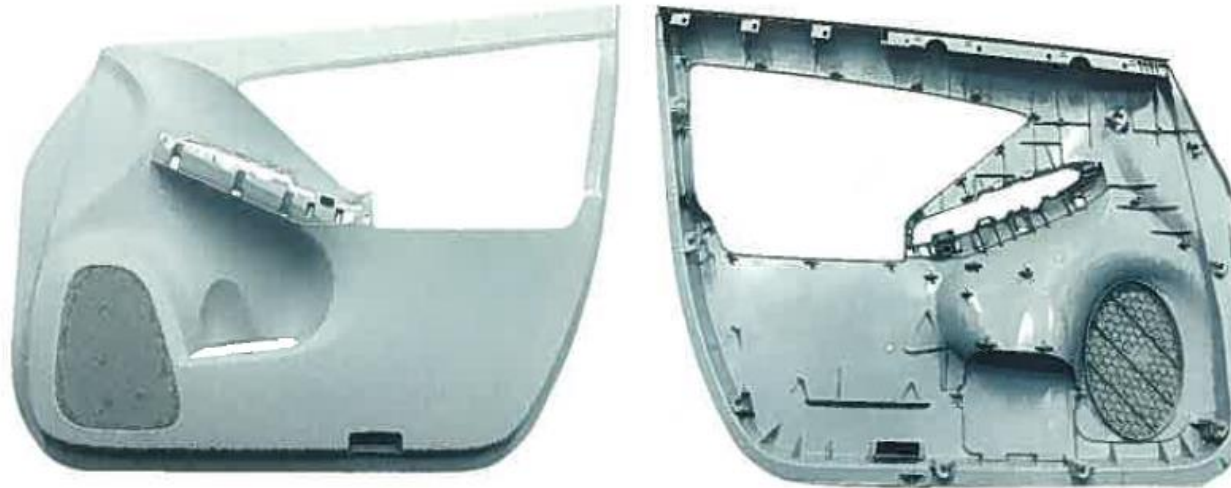
型に樹脂を流し込んだときの流れはコンピュータでシミュレーション。金型を冷やす冷却水の配管の位置や排出するポイントは航行錯誤を繰り返した。スピーカー穴も一体成形。裏にハニカム形状の増強が施してある。
