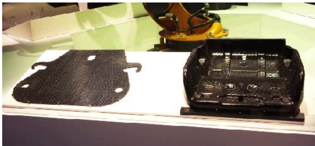
オルガノシートをオーバーモールドしたシートパン成形品
