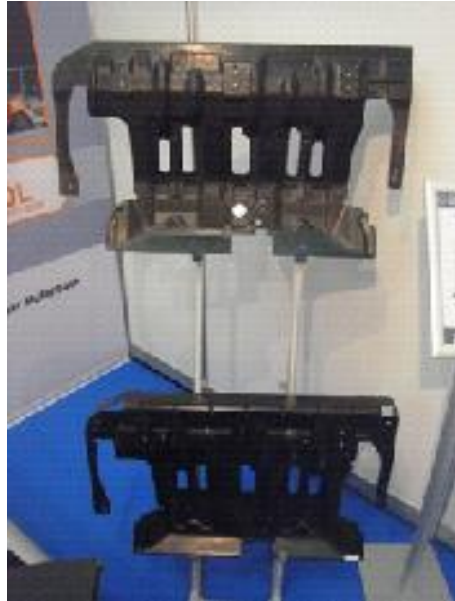
自動車アンダーカバー 下は従来の金属。重量比較用
