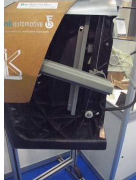
ドア内部 耐衝撃のバーは金属だが、パネルはシートモーディング。
