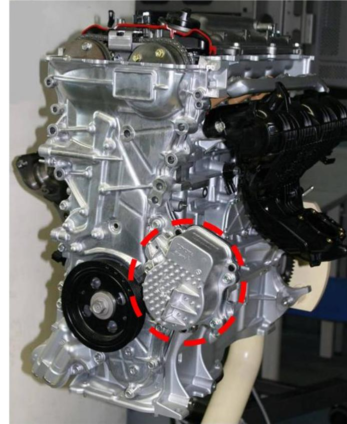
エンジン冷却用電動ウォーターポンプ（エンジン装着状態）
